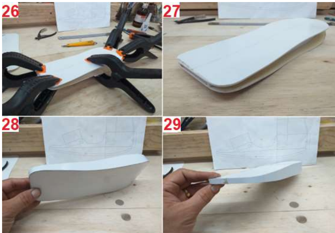
Figuras 26, 27, 28 e 29 - Construção do protótipo
