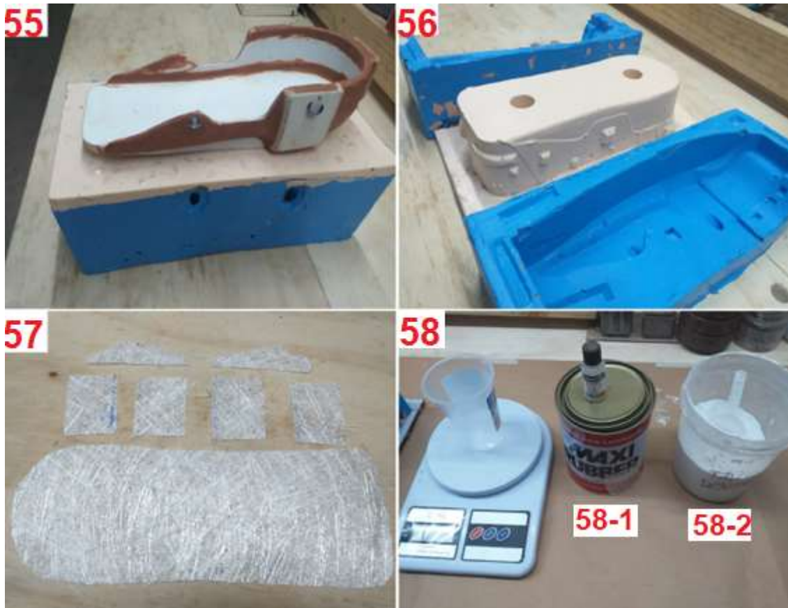
Figuras 55, 56, 57 e 58 - Construção do protótipo
